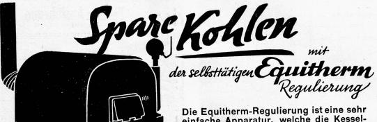
Die Equitherm-Regulierung ist eine sehr einfache Apparatur, welche die Kesseltemperatur ganz automatisch in Abhängigkeit von den Witterungsverhältnissen, mittelst einem Aussenfühler reguliert und dadurch bei geringstem Heizmittelverbrauch eine stets gleichbleibende Raumtemperatur garantiert.
