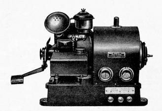
300 Watt Notstrom-Maschine mit Druckknopf-Starter
