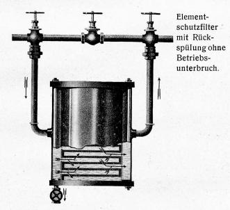
ohne weiteres jedem Bedürfnis angepaßt werden, so daß praktisch keine Druckverluste entstehen. Die Reinigung kann jederzeit ohne Demontage und ohne Betriebsstörung durch eine einfache Rückspülung erfolgen. Diese Schutzfilter erfüllen ein längst empfundenes Bedürfnis und sollten in jedes Projekt aufgenommen werden, das Anspruch auf zuverlässige Arbeitsweise erhebt.
