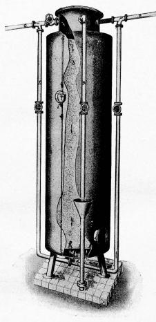
Enthärtungsapparat mit dem Basenaustauschverfahren, oder gleicher Apparat als Magno-Kleinfilter.
