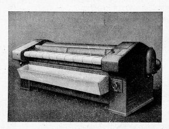
Abb. 6. Hochleistungs-Mulden-Bügelmaschine Modell »Rapid« mit automatischer Wäsche-Eingabe und Geschwindigkeits-Regulierung.
