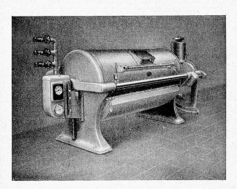
Abb. 4. Trommel-, Wasch- und Spülmaschine Modell »Normal« mit ausschwenkbarer Trommel und Instrumententableau.
