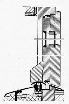
Fig. 3 Balkontüre, doppelverglast, SUPERHERMIT in Halteprofil D-2, kom-biniert mit Spezialschwelle O-11|13 für Balkonfüre, doppelverglast, Spitäler, Sanatorien etc. Ausführung: Kantonsspital Chur.
