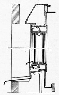
Fig. 2 Elsenfenster, doppelverglast, SUPERHERMIT in Halteprofil. D-2 u. D-4. Ausführungen: Universität Basel, Theodosianum (Operationssaal) Zürich. Ausführung in Einfachverglasung: Fabrikneubau Landis & Gyr, Zug, Schweizer Sender Schwarzenburg, Bäckereineubau des Konsumvereins Zürich, etc.
