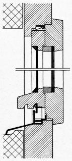
Fig. 1 Holzfenster, doppelveraglast, SUPERHERMIT in Halte-profil D-2 und D-3, kombiniert mit Regenprofil O-10.
