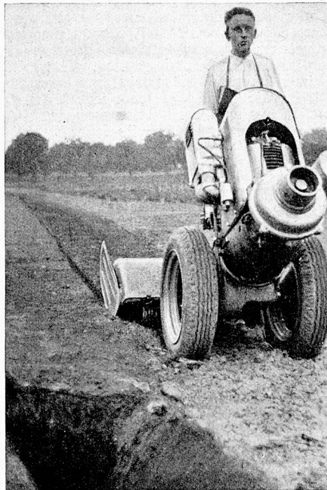
Neue 8 PS Grunder-Bodenfräse Feinste Fräsarbeit auf 30 cm Tiefe (langsamer Gang bei schneller Drehzahl der Fräse)
