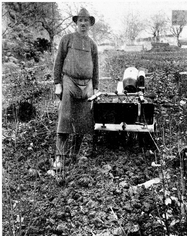
Neue 8 PS Grunder-Bodenfräse Schollen-Struktur (Schnellgang bei langsamer Drehzahl der Fräse)
