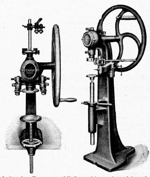
arbeitenden Dosenverschließmaschine, wie solche obenstehend abgebildet sind. Die Maschinen werden hergestellt von der Ferrum A.-G. in Rupperswil bei Aarau. Vorsicht ist geboten bei Verwendung von verschiedenen "Patent - Dosen", die ohne Maschine verschlossen werden können. In vielen Fällen vermögen diese Dosen nicht zu genügen. Es darf darauf hingewiesen werden, daß nur ein Verschluß der Dosen, wie solcher auch in den Konservenfabriken bewerkstelligt wird, voll genügen kann genügen kann.
