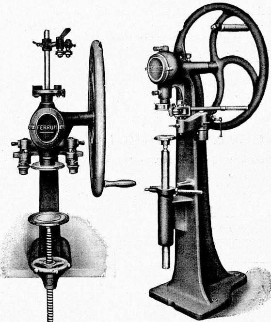
arbeitenden Dosenverschließmaschine, wie solche obenstehend abgebildet sind. Die Maschinen werden hergestellt von der Ferrum A.-G. in Rapperswil bei Aarau. Vorsicht ist geboten bei Verwendung von verschiedenen „Patent-Dosen“, die ohne Maschine verschlossen werden können. In vielen Fällen vermögen diese Dosen nicht zu genügen. Es darf darauf hingewiesen werden, daß nur ein Verschluß der Dosen, wie solcher auch in den Konservenfabriken bewerkstelligt wird, voll genügen kann.
