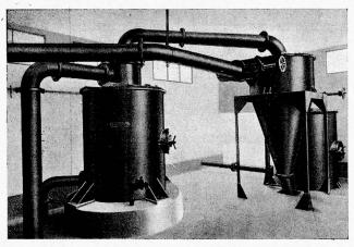
Fig. 6 Transport pneumatique du combustible. Séparateur d'air et filtre.
