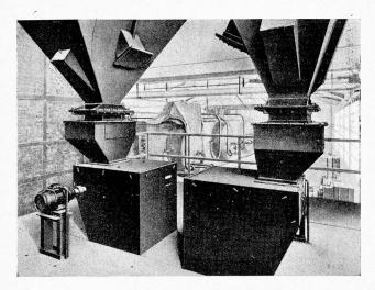
Fig. 5 Balances automatiques Chronos pour le réglage d'admission et le mesurage du combustible.
