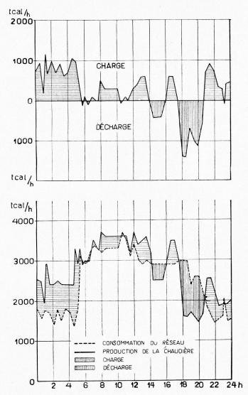
Fig. 9 Diagramme journalier des besoins de chaleur du réseau et courbe de charge et de décharge des accumulateurs. Tagesdiagramm des Netzwärmebedarfs und Lade-, bzw. Entladekurve der Speicher.
