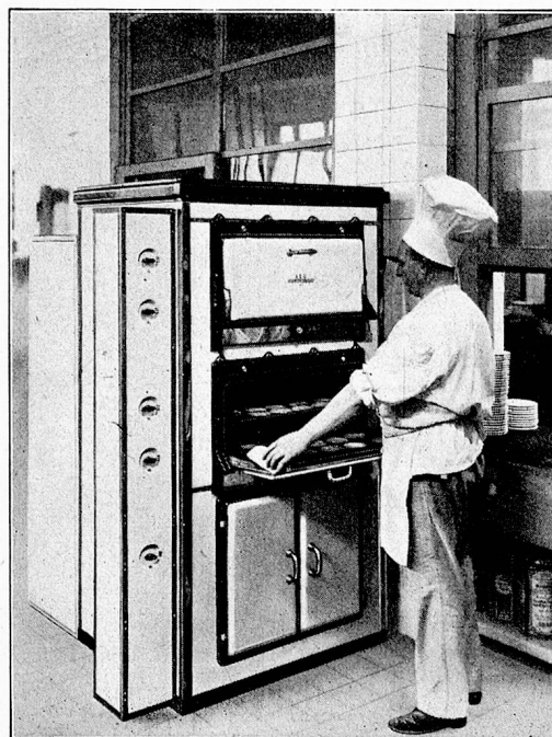
Elektrokonditorei - Backofen mit 2 Backröhren und einem Gärschrank
