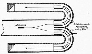
Abbildung 12 Beispiel der Isolierung eines Luftkanales gegen Raumschall-Uebertragung
