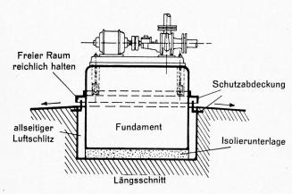
Abbildung 2 Versenktes Fundament für Pumpenaggregat
