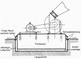
Abbildung 5 Versenktes Fundament, gemeinsam für Ventilator u. Antriebsmotor
