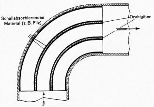
Abbildung 11 Bogen-Schalldämpfer
