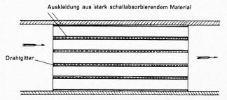
Abbildung 9 Schalldämpfender Einbau für Luftkanäle, deren Querschnitt nicht erweitert werden kann
