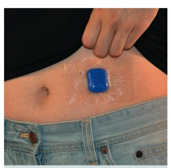
Le détecteur de chute se fixe sur le corps à l'aide d'un pansement adhésif. Photo: BFH
