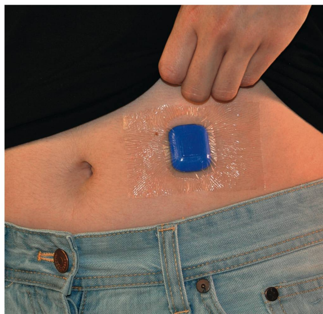
Le détecteur de chute se fixe sur le corps à l'aide d'un pansement adhésif.
