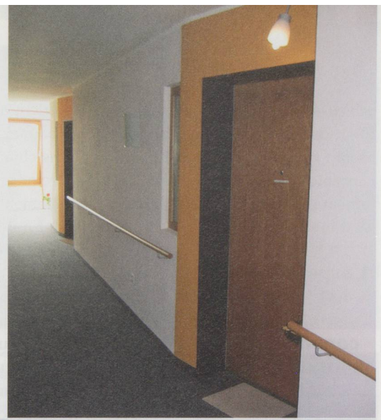
Des portes qui se fondent dans les parois de même couleur: les personnes souffrant de déficit visuel n'ont aucune chance de retrouver leur chambre (à g.). Des couleurs contrastées, des portes renfoncées et une entrée clairement signalée: exemplaire (à d.)
