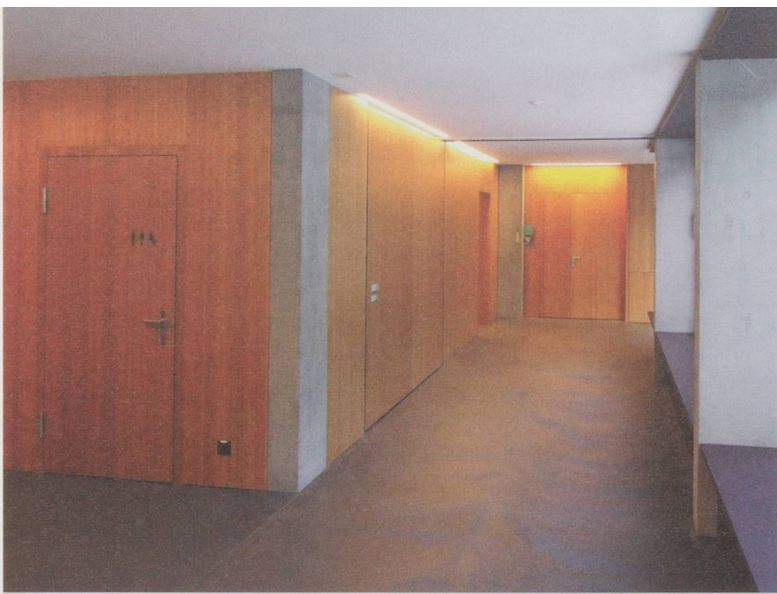
Des portes qui se fondent dans les parois de même couleur: les personnes souffrant de déficit visuel n'ont aucune chance de retrouver leur chambre (à g.). Des couleurs contrastées, des portes renfoncées et une entrée clairement signalée: exemplaire (à d.)
