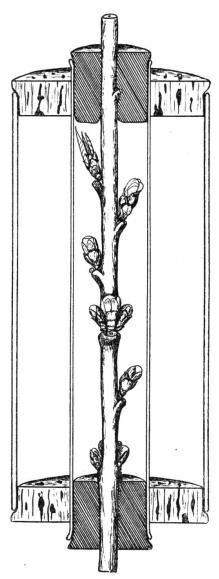
Fig. 10. Appareil employé au champ d'essais pour geler les bourgeons avant de les inoculer.
