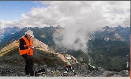
Abb. 3.3 Alle Markierungspunkte wurden von Vincent Somerville und Timothée Produit per GPS eingemessen und georeferenziert.
