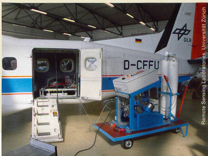
Abb. 2 Dornier DO-228 mit dem Bildspektrometer Apex
