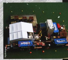
Abb. 2 Installationsplattform für Sättigungstauchen (Beispielbild)
