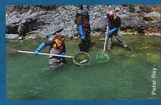
Instrumente für die Erfolgskontrolle der Restwassersanierung: Elektroabfischung
