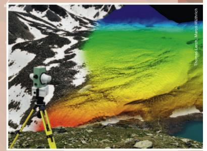
Visualisierung der Oberfläche des Blockgletschers Macun, eingefärbt nach den Höhenwerten der Punkte (rot: tief, blau: hoch)
