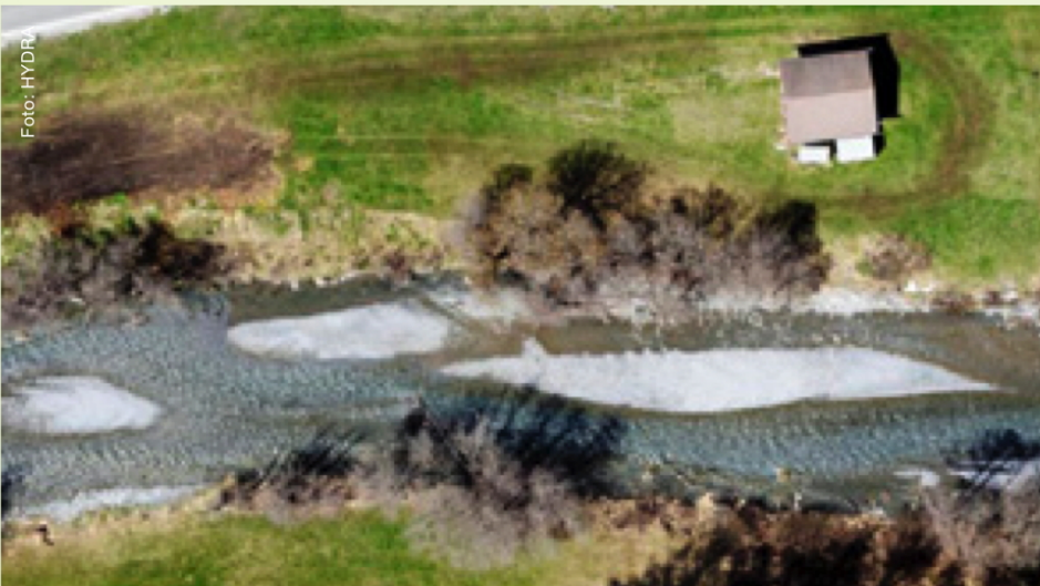
Abbildung 2 Spöl oberhalb Holzbrücke Zernež: Bei der Spülung wurden die Kiesablagerungen erodiert. oberes Bild: 06.05.2009 unteres Bild: 05.08.2009
