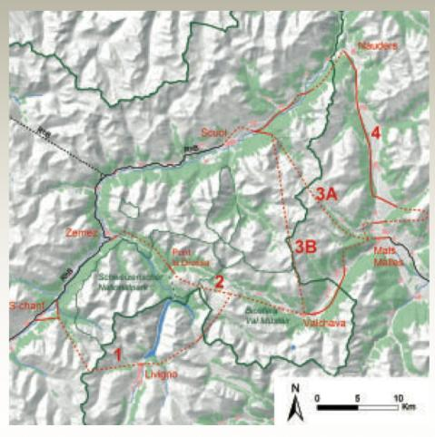
Abbildung 1: Linienvarianten einer möglichen Bahnverbindung zwischen dem Unterengadin (Zernez, Scuol) und dem Obervinschgau (Mals). Karte: Interreg-III-A und GIS-SNP
