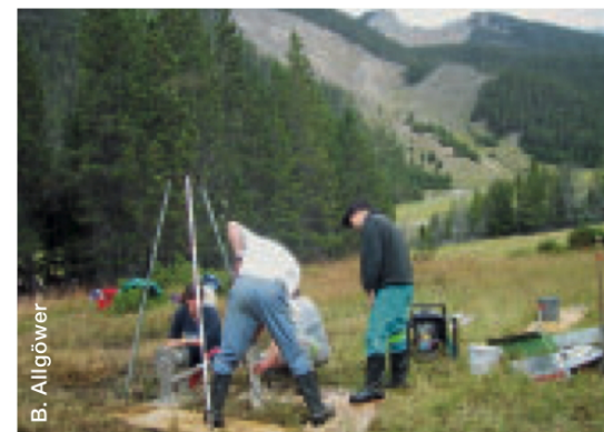
Abbildung 3: Entnahme des Bohrkerns zur Langzeitfeuergeschichte bei Il Fuorn. Im Hintergrund ist die Brandfläche aus dem Jahre 1951 sichtbar.
