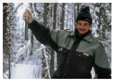
Andri Cuonz wiegt den Schnee, der sich im Niederschlagsmesser angesammelt hat und notiert das Gewicht. Anschliessend wird der Schnee geschmolzen und das Schmelzwasser an die WSL zur Analyse geschickt.
