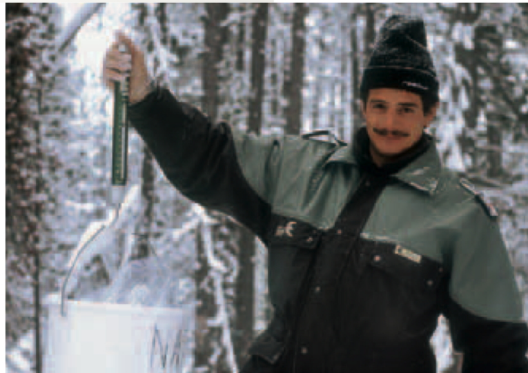
Andri Cuonz wiegt den Schnee, der sich im Niederschlagsmesser angesammelt hat und notiert das Gewicht. Anschliessend wird der Schnee geschmolzen und das Schmelzwasser an die WSL zur Analyse geschickt.
