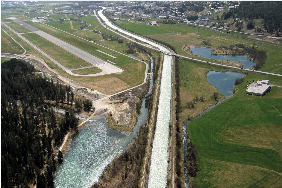
Bild 1: Bauarbeiten zur Ver- legung des Flazbaches mit neuer Mündung in den Inn oberhalb des Gravatscha-Sees
