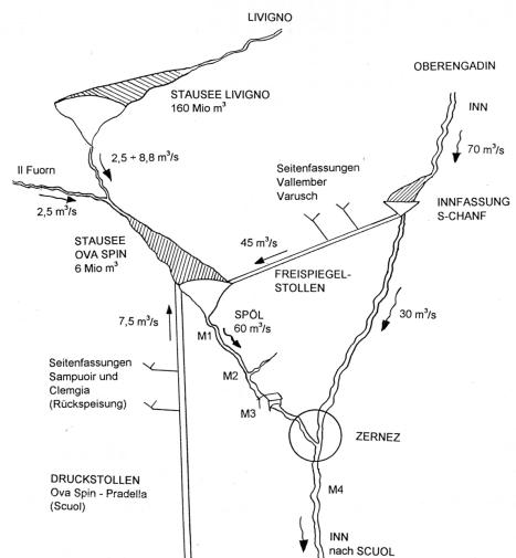
Abb.1: Übersichtsskizze mit den wichtigsten Orts- und Flussbezeichnungen und den während der Spülung fliessenden Wassermengen. Messstellen: M1: Laschadura, Absetzmessung, Sauerstoffmessung. M2: Cluozza, wissenschaftliche Begleitung durch HYDRA-Konstanz, Absetzmessungen, chemische Analysen, Sauerstoffmessung. M3: Holzbrücke Zernez, Absetzmessung, Überwachung Pegelstand. M4: Inn, Zernez, Absetzmes-
