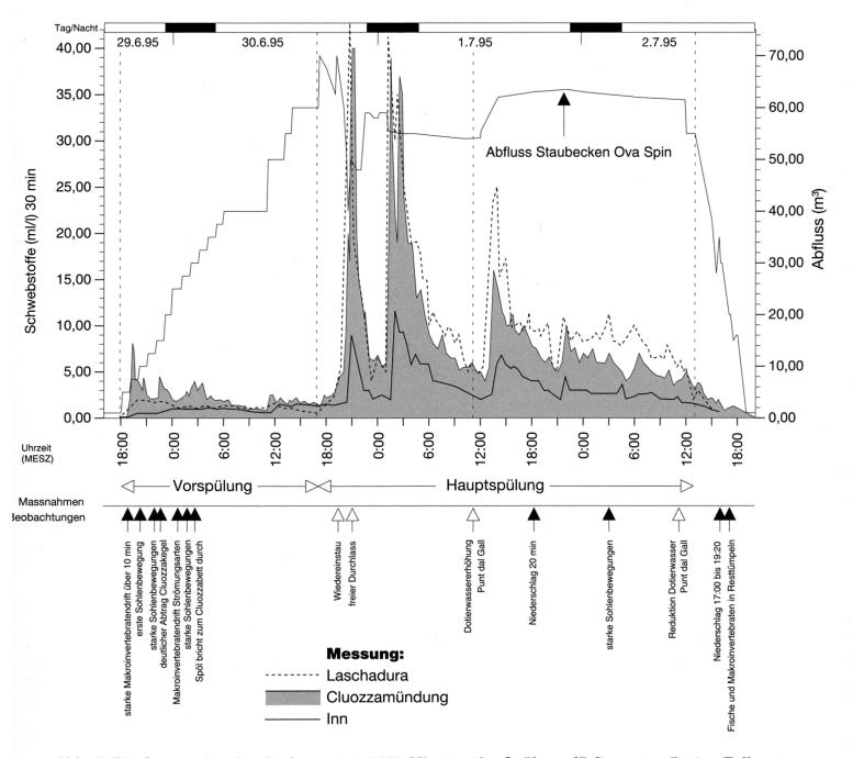
Abb. 3: Die Suspensionsfracht der ersten 1400 Minuten der Spülung dürfte zum grössten Teil aus dem Spölbett stammen. Die später auftretenden Frachtspitzen sind jeweils auf kurzzeitig freien Durchfluss im leeren Staubecken zurückzuführen.
