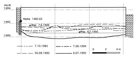
Abb. 8: Spöl - Querprofil bei der Holzbrücke, Flusskilometer 1.126 (Fig. 1). Profile 1985/92 nach Kant. Amt für Flussbau, Profile 1994/95 nach eigenen Aufnahmen.
