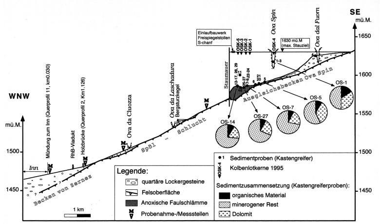
Abb. 5: Schematisches Längsprofil vom Staubecken Ova Spin bis zum Inn. Eingetragen sind Probenahmepunkte und Messstellen am Spöl während der Spülung. Die Signaturen für die Kolbenlotproben sind an der Wasseroberfläche eingetragen. Die entsprechenden Proben wurden aber immer am tiefsten Punkt im entsprechenden Seequerprofil gezogen. Der minerogene Rest der Proben besteht aus Calcit, Quarz, Glimmer, Feldspat und wenig Hornblende.
