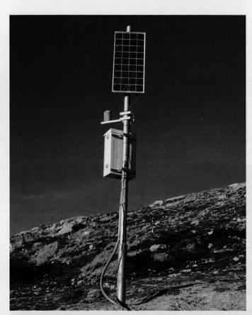
Abb. 2: Messmast mit Datenerfassungsgerät. Das Solarpanel versorgt die Klimastation mit Strom und Wärme.
