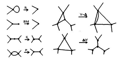
Figure 1. Les transformations électriques élémentaires.
