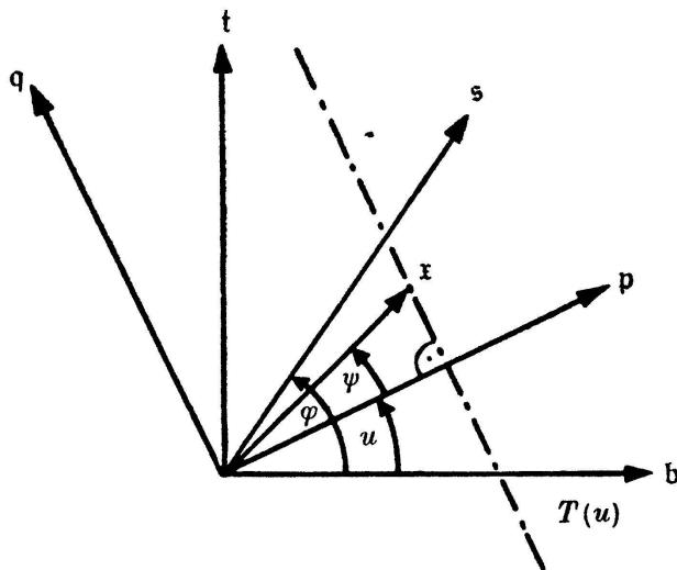
Aus dem Gleichungssystem  $T(u) = 0$  und  $\dot{T}(u) = 0$ <sup>7)</sup> ergeben sich die Koordinaten des Berührungs punktes und damit die Parameterdarstellung der Meridianlinie :
