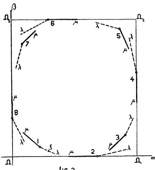
Dans celle-ci le polygone se trouve encadré par le rectangle  $\Omega\Omega_1\Omega_2\Omega_3$  dont les côtés sont parallèles aux axes  $\Omega\alpha$  et  $\Omega\beta$ .
