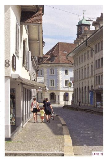
[ABB.2] Im Zentrum von Langenthal wurden zum Schutz vor Hochwasser Hochtroittoirs angelegt./ Dans le centre de Langenthal, l'aménagement de trottoirs surélevés offre une protection contre les inondations./ Nel centro di Langenthal sono stati costruiti marciapiedi rialzati a protezione dalle inondazioni. (Quelle: M. Jegerlehner)
