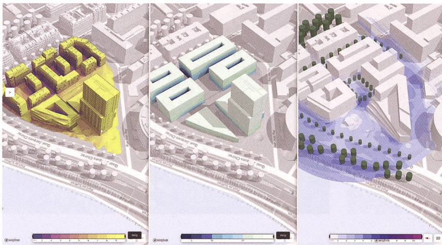
[ABB.4] Verschiedene Lösungsvarianten vergleichen, generiert durch Autodesk Forma / Comparer les différentes variantes générées par Autodesk Forma / Soluzioni a confronto, grazie a varianti generate da Autodesk Forma (Quelle: auxalia GmbH)
