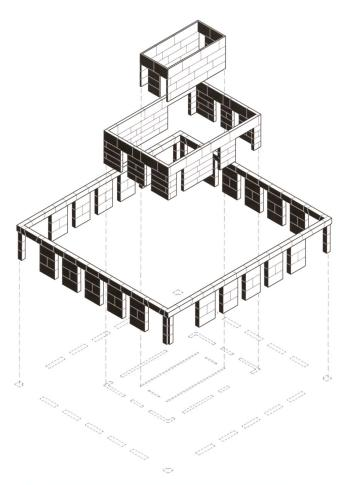
[ILL.4] Axonométrie constructive: trois couronnes en pierre massive/ Assonometria costruttiva: tre corone di pietra massiccia Axonometrie: Drei Mauerringe aus Massivstein (Source: atelier archiplein, en association avec Perraudin architectes)
