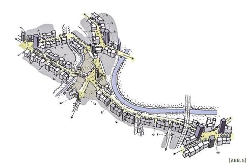
[ABB.5] Ausschnitt Stadtboulevard Dietikon (Hochhauskonzept): Mehrheitlich überdimensionierte Verkehrsinfrastruktur erfordert eine orts- und städtebauliche Reparatur. In diesem Zusammenhang sind Strassenräume zu redimensionieren und in ihrer ortsbaulichen Prägnanz zu schärfen. Ein differenzierter Umgang mit den direkt angrenzenden Grundstücken und Bausteinen ist unerlässlich. (Quelle: Van de Wetering / Stadt Dietikon)
