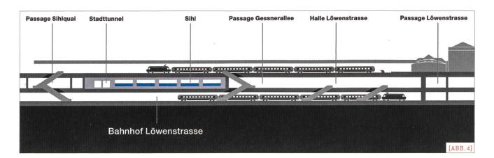
[ABB.4] Schema Sihl-Durchfluss beim Hauptbahnhof Zürich.
