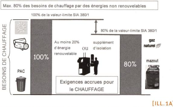
**[ILL.1A/1B/1C]** Les contraintes légales en matière de chauffage, de production d'eau chaude sanitaire et de coefficient d'occupation du sol de la LVLEne. (Source: Service cantonal de l'environnement et de l'énergie, novembre 2006)
