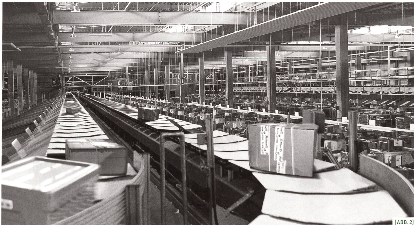
[ABB. 2] Sortieranlage für Postpakete (Foto: Postlogistics, Bern)
