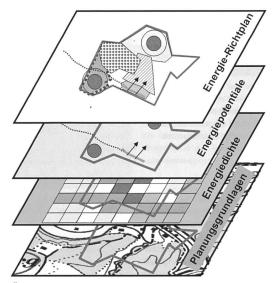
Überlagerung verschiedener GIS-Daten zur Erstellung eines Energierichtplanes.
