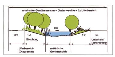
Fig. 1: Minimaler Raumbedarf aus der Sicht Hochwasserschutz
