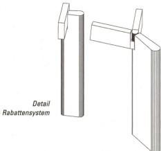
Für das neue Rabattensystem entwickelte «element» zwei verschiedene Stütztypen aus Baubronze. Der so genannte Überfahrschutz wirkt dank seiner Tropfenform defensiv. Bild: © element
