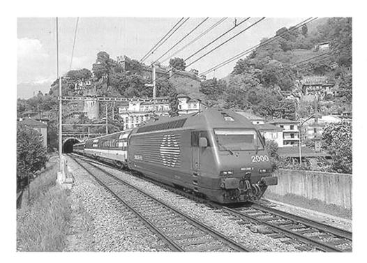
Die HGV in der Schweiz bestehen mehrheitlich als Ausbaustrecken mit Höchstgeschwindigkeiten von 160 bis maximal 200 km/h. (Bild SBB, Ausbaustrecke Aarau)
