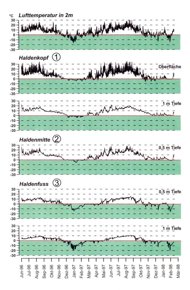
Abb. 4: Temperaturverlauf an der Blockhalde "Seehalde" bei Präg mit Angabe der Messpunkte (siehe Abb. 3).
