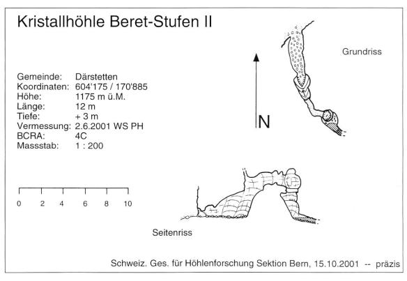
Fig. 2: Die Pläne der beiden Höhlen. Die erste Calcitlage ist zu dünn, um im Massstab sichtbar zu sein, die zweite Lage ist durch horizontale Striche charakterisiert. Punkte stellen Lehm und Sand dar, eine Linie mit senkrechten Strichen einen Absatz.
