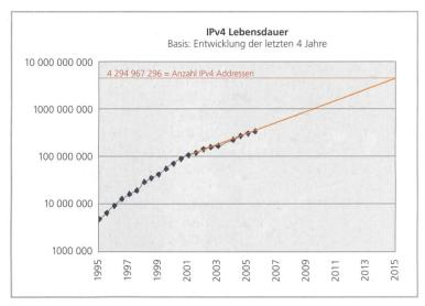
Bild 2. Extrapolation der im Internet aktiven Rechner.
