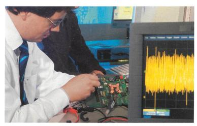
Bild 4. Extrahiert man aus Baugruppen so konventionelle Informationen wie den zeitlichen Ablauf des Stromverbrauchs oder den Verlauf der elektromagnetischen Strahlung während des Ablaufs kryptografischer Operationen, kann man statistische Rückschlüsse auf die verwendeten Verschlüsselungsverfahren ziehen. Im Labor von Siemens wird an Verfahren zur Abwehr solcher «Seitenkanalattacken» gearbeitet. Siemens AG
