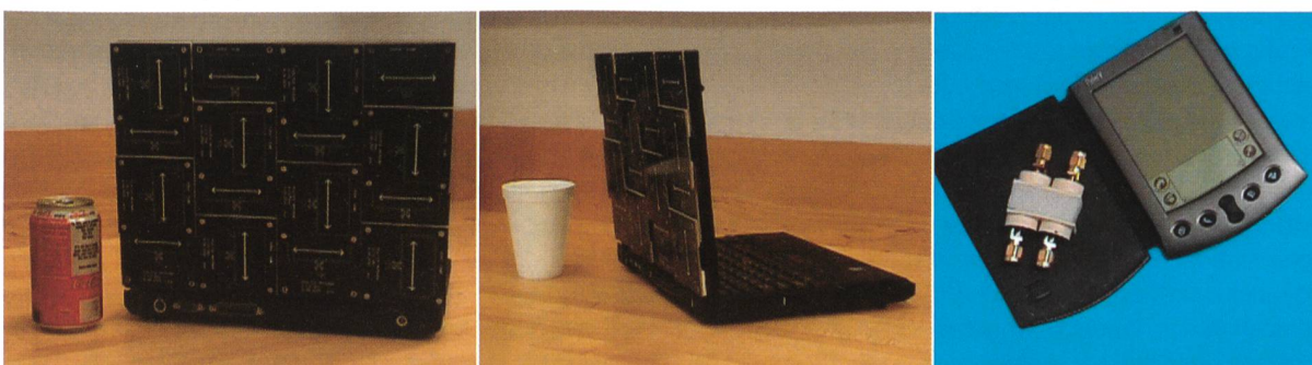
Bilder 2a, b und c. Laptop und PDA mit MIMO-Technologie in einer Versuchsanordnung von Lucent Technologies.
