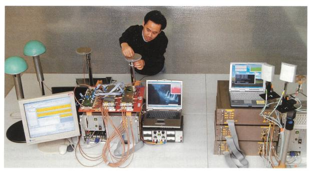
Bild 3. MIMO-Versuchsanordnung von Siemens.
