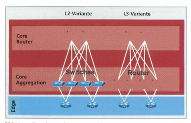
Bild 4. Layer-3- und L2-Dual-Star-Aggregation.
