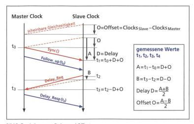
Bild 3. Ermittlung von Delay und Offset.
