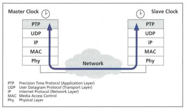
Bild 2. Kommunikation zwischen Master und Slave.
