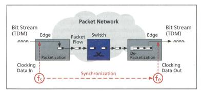
Bild 1. Prinzip der Nachbildung von TDM-Leitungen durch ein Paketnetz (in der Regel Duplex, es ist aber nur eine Richtung dargestellt). Ziel ist es, beim Empfänger den Service-Takt  $f_{\rm e}$  möglichst genau dem Takt  $f_{\rm s}$  des Senders nachzuführen.
