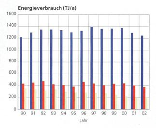
Bild 2. Entwicklung des (blau) Elektrizitäts-, (rot) Wärmeund (grün) Treibstoffverbrauchs von Swisscom; bis 1996 nur Teilbereich Telecom der damaligen PTT (ohne Gewichtsfaktoren; 1 GWh/a = 3,6 TJ/a, a: Jahr, T: Tera = 10<sup>12</sup>).
