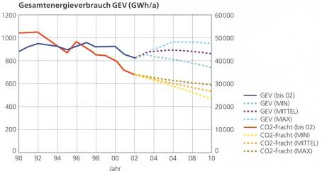
Bild 4. Gewichteter Gesamtenergieverbrauch (Elektrizität + Brennstoffe + Treibstoffe) bzw. CO2-Fracht von Swisscom: aus erfassten Energiedaten bis 2002 (ausgezogene Linien) und je nach Entwicklungsszenario ab 2003 (MIN-, MITTL bzw. MAX-Szenario, gestrichelte Linien).
