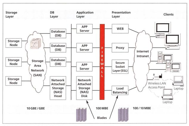
Bild 2. Typisches Einsatzbeispiel für Blades in Data-Centern.
