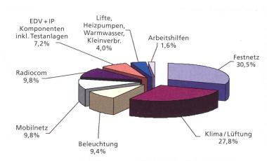
Bild 1. Aufteilung des Elektrizitätsverbrauchs von Swisscom nach Verwendungszwecken im Jahr 2002.
